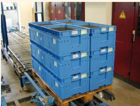
Palette mit Kleinladungsträgern ausgestattet mit RFID (IFT 2006)
